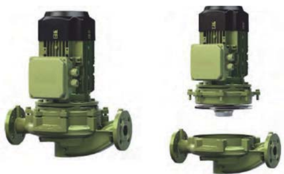
Pompy monoblokowe – wirnik na wale silnika (dla rozmiaru do DN65)
